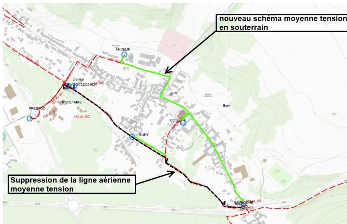
Les travaux consistent à poser de nouvelles liaisons HTA souterraines avant la suppression de la ligne aérienne.
